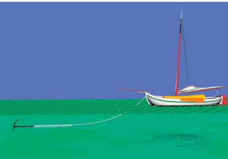
Tekening 3. lengte ankerlijn Als het anker houdt en je viert de ankerlijn tot deze door gaat hangen, is de kracht op het anker heel constant en is de kans op uitbreken het kleinst.
