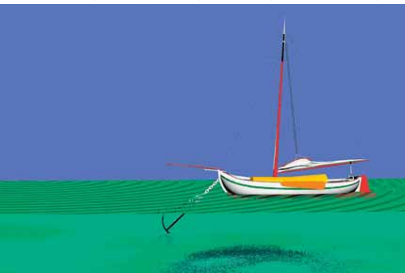
Tekening 2. Het anker breekt uit als het omhoog getrokken wordt.
