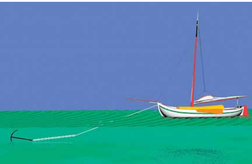
Tekening 1. Hoe langer de ankerlijn, des te makkelijker kan het anker zich ingraven.
