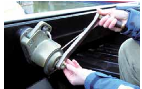
Zwaardlieren: haal altijd de hendel eruit!
