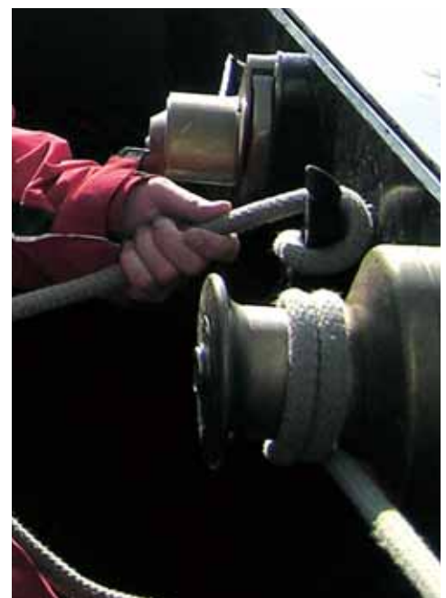
De lijn loopt enigszins van onderen naar de trommel.
